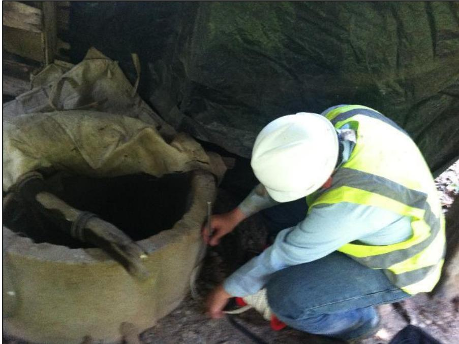
**Figura 36: Ejercicio del inventario de puntos de agua en los alrededores del casco urbano de Jerusalén (Cundinamarca). En este ejercicio se observa la medición del nivel freático utilizando una sonda de nivel marca Solinst.
