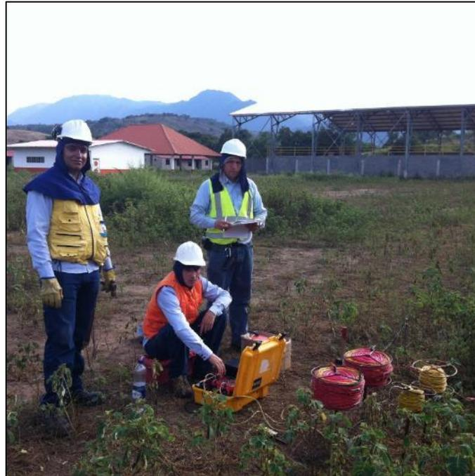
**Figura 17: Adquisición del Sondeo Eléctrico Vertical 1.**
