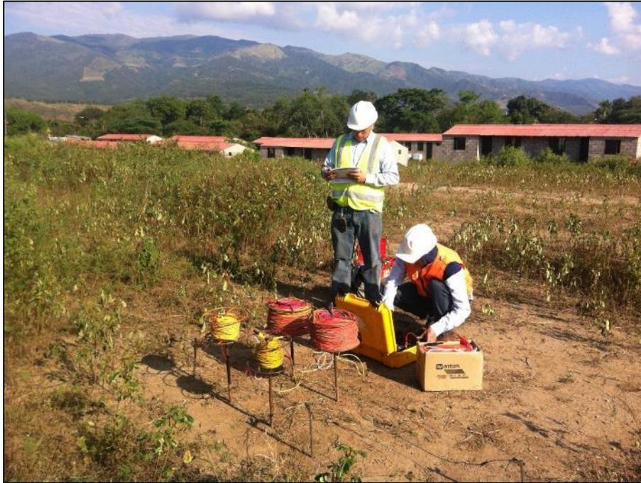
**Figura 20: Adquisición del Sondeo Eléctrico Vertical 2.**
