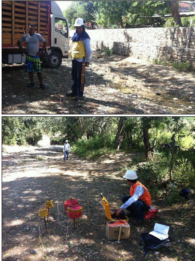
**Figura 37: Alrededores del SEV-3. Arriba, gaviones que protegen algunas casas de Jerusalén en caso de crecida de la quebrada La Limba. Abajo, localización del SEV-3 en zona de inundación de la quebrada La Limba.**
