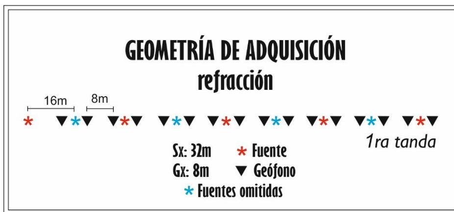
Figura 20. Geometría de adquisición para la línea de refracción resaltando las características de la misma.
