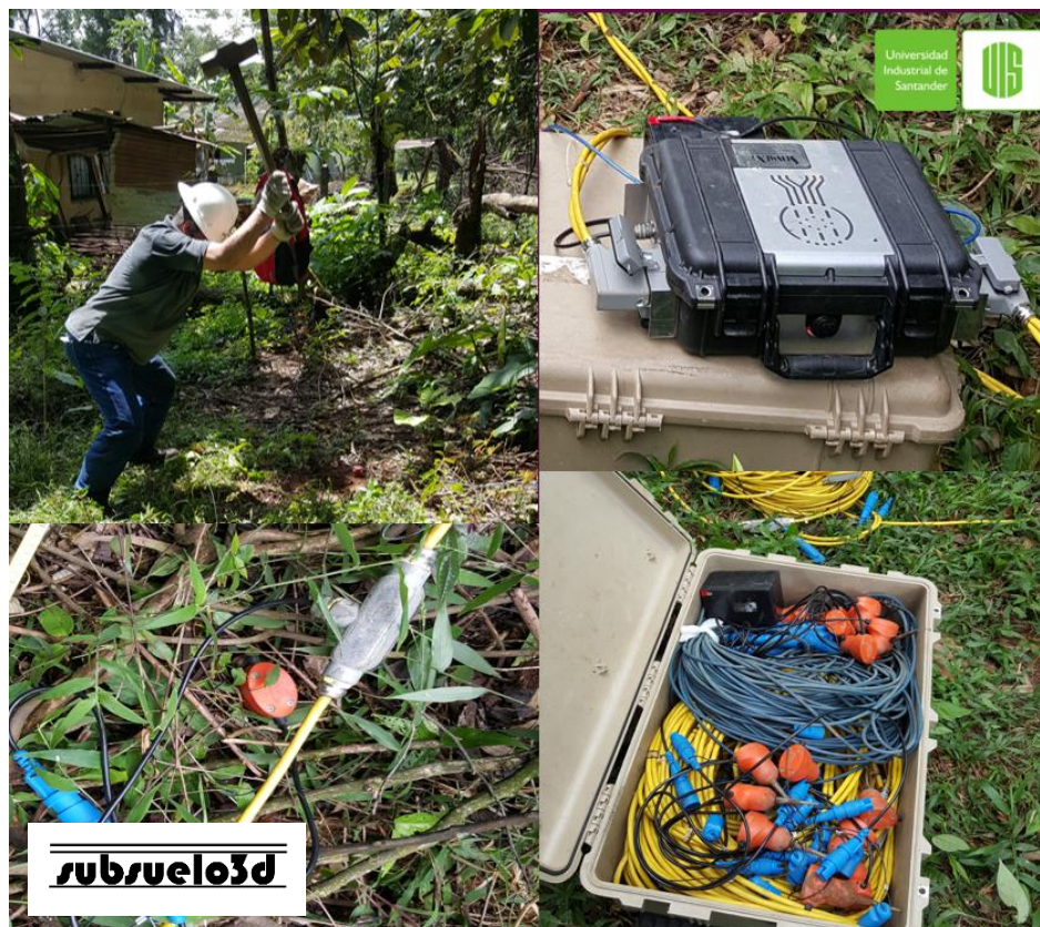
Figura 15. Equipo SeisMex16 utilizado en la investigación.
